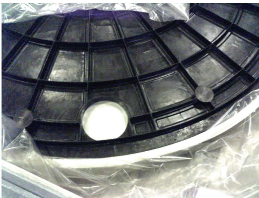
Рис. 1. Фрагмент размеростабильной углепластиковой интегральной конструкции центрального зеркала D=2,6\text{ м} радиотелескопа «Спектр-Р»
