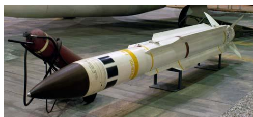
Рис. 4. Ракета с носовым радиопрозрачным обтекателем заостренной формы [10]
