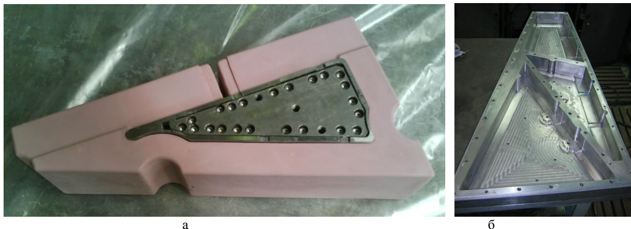
Рис. 1. Фотография терморасширяющейся оправки (а) и матрицы для её изготовления (б)
