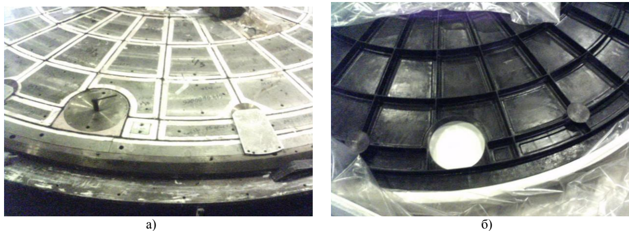
Рис. 4. Фотографии фрагмента оснастки (а) и фрагмента размеростабильной углепластиковой интегральной конструкции центрального зеркала D=2,6\text{м} радиотелескопа «Спектр-Р»
