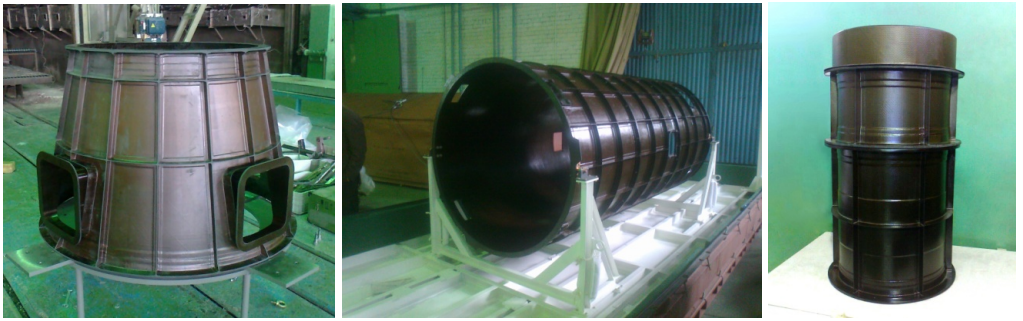
Рис. 7. Размеростабильные элементы несущих конструкций корпусов оптико-электронных комплексов космических аппаратов (фото из [12])
